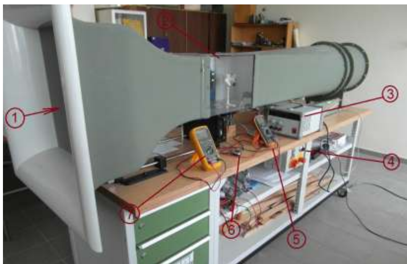
Stanowisko do badań turbiny wiatrowej.
